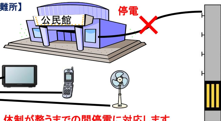
EVから避難所に必要な電源を供給し、体制が整うまでの間停電に対応します
