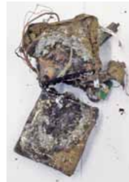
▲強い衝撃で発火したモバイルバッテリー
