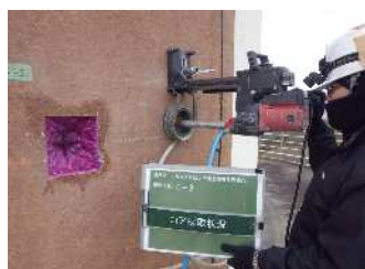
－左：コア採取の状況 右：ボーリング調査の状況－
