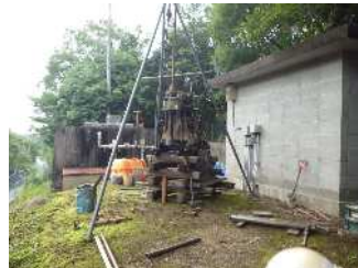
－左：コア採取の状況 右：ボーリング調査の状況－
