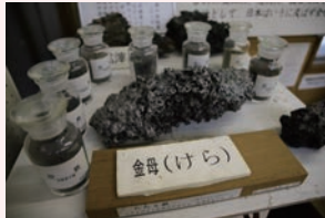
たたらで精錬された鉄の塊「金母(けら)」。この中にごく僅かな鋼が含まれている。
