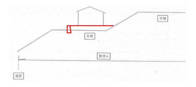
5. 計画図に示す道路A、道路B及び道路Cに面する敷地については、各道路から引込電柱等が目立たないように配慮する。少なくとも各道路に面する外壁後退部分や法面には引込電柱等は設置しないこととする。
