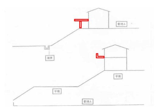
(2) 同一敷地内の建物をつなぐペデストリアンデッキの設置は許可する。ただし、できるかぎり法面に支柱等は設置しないよう指導する。
