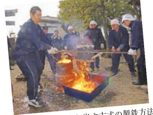
砂鉄と木炭から鉄を取り出す古式の製鉄方法「たたら製鉄」が、三木金物古式鍛錬技術保存会の和銅製鉄部会により行われ、約10キロの鋳が取り出されました。（2月14日）
