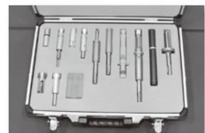
▲金属拡底式アンカーシステム ANZEX-K
