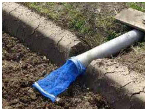
取水口への網の設置
