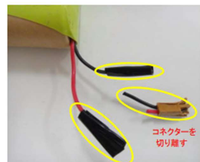
(コネクターを切り離しリード線の 先端を絶縁／リード線は短絡防止 のため1本ずつ切断)
