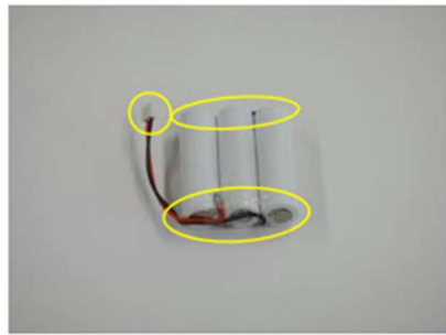
(電池端子連結部／コネクター部の露出)
