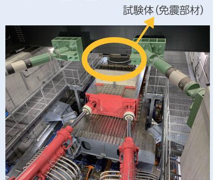
▲実大免震試験機を使用した実験の様子
