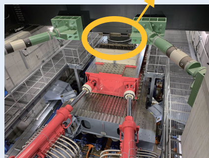
▲実大免震試験機を使用した実験の様子
