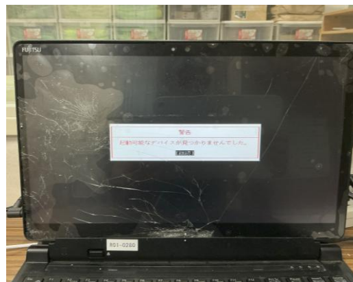
電源ON時画面 （画面破損）
