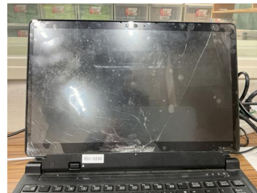
正面（画面破損）
