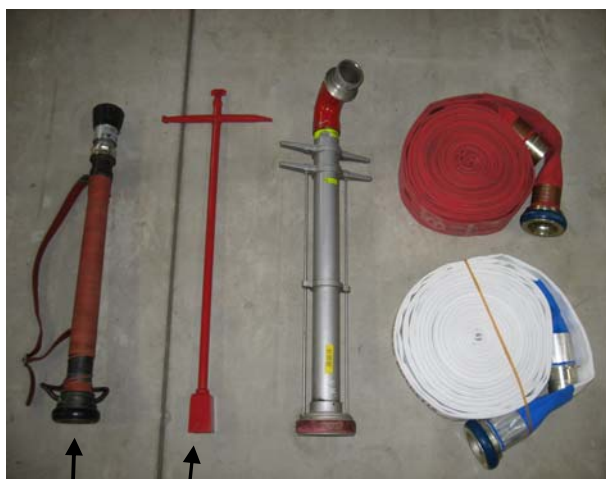
筒先 消火栓キー スタンドパイプ
