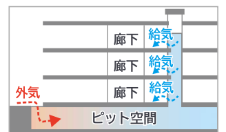
[クール・ヒートトレンチ]
